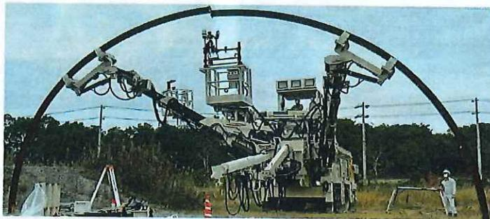
写真 10 微調整機能付きエレクター搭載型吹付けロボット
