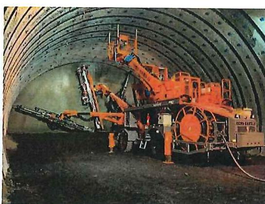
写真 13 ロックボルト打設専用機
